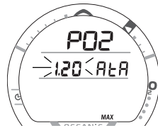
Fig. 34 - Set PO2 Alarm
